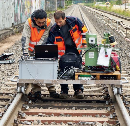
**BILD 4:** Mobile Einrichtung zur Messung des QVW
